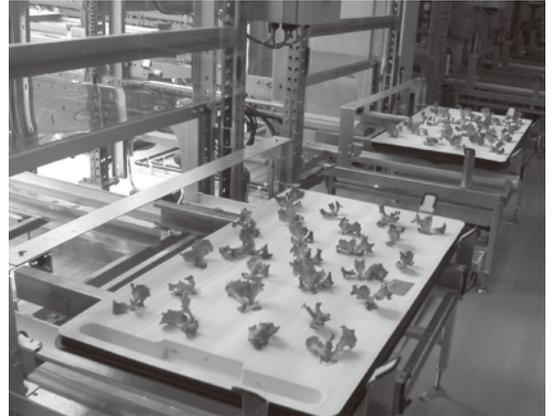
図-2 樹脂成型品の栽培ベッド
