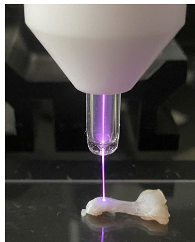
図1：摘出したラットのアキレス腱に低温大気圧プラズマを照射する様子。
