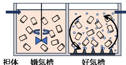
図 2 流動床式生物膜担体処理法 (MBBR) の模式図
