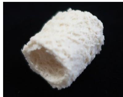
図1 ポリプロピレン製の発泡担体
