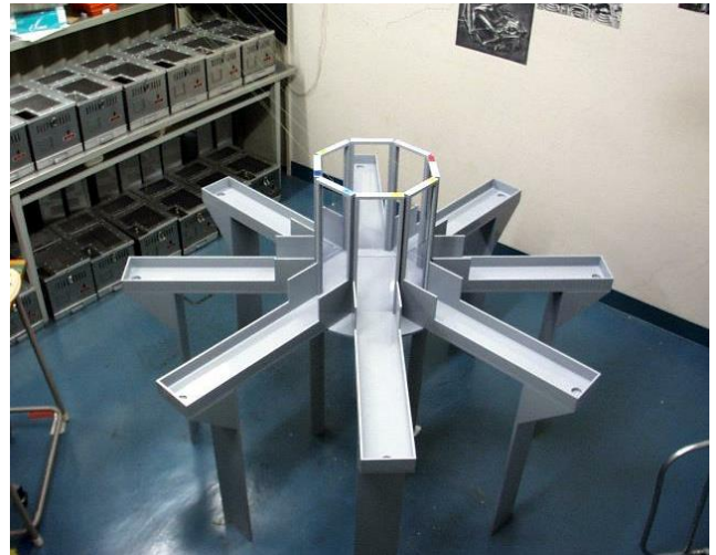
図 1 放射状迷路。8 本の選択枝が中央の八角形のプラットフォームから放射状に伸び出した形で設置された迷路である。
