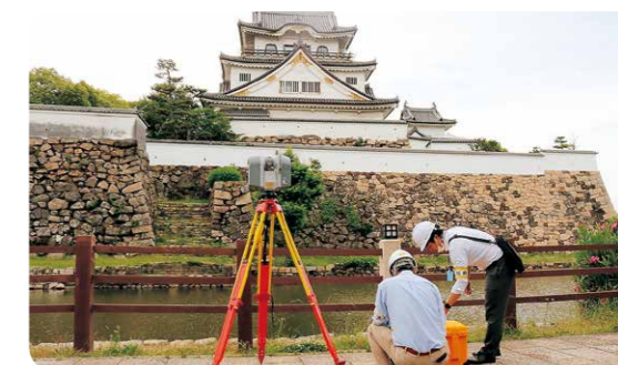
据置型レーザースキャナを用いた計測作業の様子
