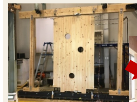
実験により耐力壁を開発
